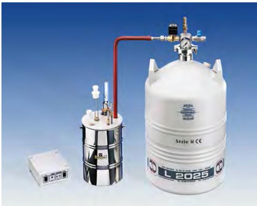
*Automatische LN2-Niveauregulierung für manuelle Schrumpfungsvorrichtungen mit zwei Halter für die zu schrumpfenden Buchsen, Dewarge-fäß, Deckel, Abgasrohr und einem 35 Liter LN2 Behälter. Best. Nr. 2760-35*
