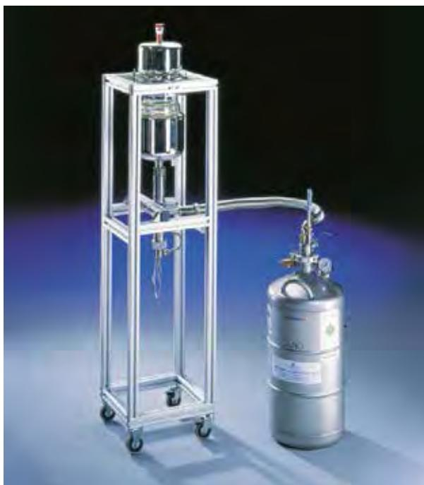
KALTGAS-System Typ TG-RID 40/50 für einen Temperaturbereich von +120°C bis -160°C, mit einer Temperaturstabilität bis +/- 0,2°C.
