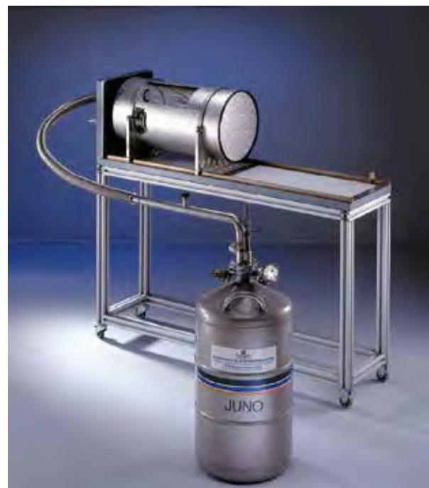
KALTGAS-System Typ TGK-40/50 für einen Temperaturbereich von +80°C bis -160°C, mit einer Temperaturstabilität bis +/- 0,2°C. Die Kammer besitzt ein großes Sichtfenster.
