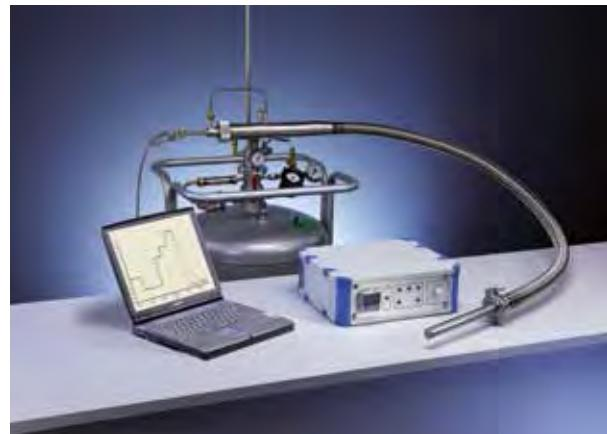
KALTGAS-System Typ TG-LKF-H für einen Temperaturbereich von +120°C bis -180°C, mit einer Temperaturstabilität bis +/- 0,2°C.
