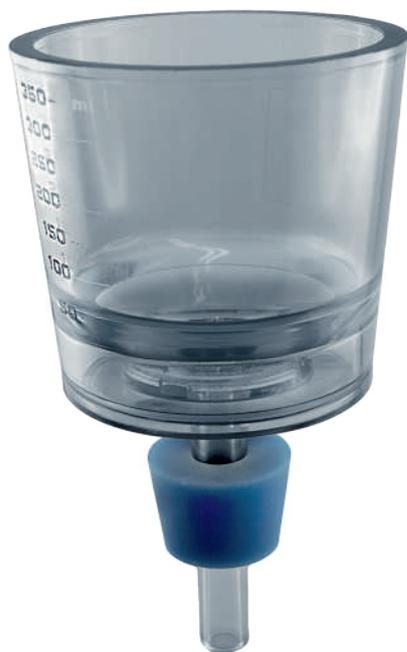
Автоклавируемый фильтродержатель GVS Life Sciences сочетает в себе ряд ключевых свойств и преимуществ, делающих его крайне ценным инструментом. Для начала, он состоит всего из двух частей. В нем нет зажимов или фиксирующих устройств. Уникальная конструкция, герметизирующаяся под действием гравитации, позволяет работать одной рукой без опасности тока жидкости в обход фильтра или вытекания образца при использовании объемных фильтров.
