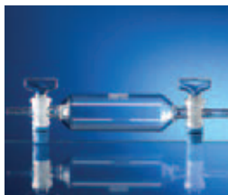
GASPROBEROHRE (Gasmäuse) DIN 12 473 mit zwei Einweghähnen mit massivem Glasküken mit Gewinde und Schraub- sicherung, Inhaltsangabe und Beschriftungs- feld auf dem Körper ohne Ent- nahmestutzen
