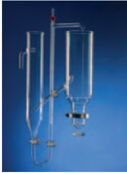
BESTIMMUNG DER BIOLOGISCHEN ABBAUBARKEIT UNTER ANWENDUNG SPEZIELLER ANALYSENVERFAHREN (L 24) DIN 38 412 Teil 24 (DEV)
