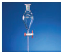
SCHEIDETRICHTER; KONISCHE FORM DIN 12 451, ISO 4800 graduierter Hahn mit PTFE-Küken
