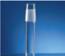
KEGELSCHLIFF KERNE MIT VERLÄNGERUNG DIN 12 242 NS-Kerne mit Verlängerung, einseitig geschliffen, Rohrende verschmolzen mit abgerunde- ten Schliff-rändern
