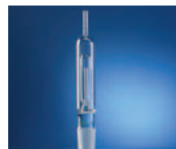
ABSORPTIONSGEFÄSS ZUR BESTIMMUNG VON: CYANIDEN (D13 + D14) SÄURELÖSLICHEM ANTEIL VON METALLEN (S 7) PHOSPHOR IN SCHLÄMMEN UND SEDI-MENTEN (S 12) DIN 38 405 - Teil 13+14 (DEV) DIN 38 414 - Teil 7 + 12 (DEV)
