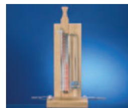
VAKUUMMETER NACH BENNETT auf Holzstativ mit verschiebbare Skala
