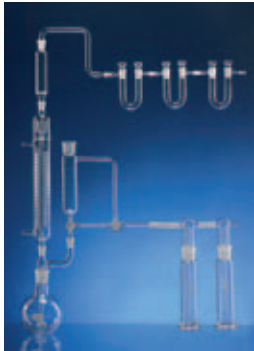
BESTIMMUNG DER SUMME DES GELÖSTEN KOHLEN-DIOXIDS (G 1) DIN 38 408 Teil 1 (DEV) bestehend aus Stehkolben, Gaswaschflaschen, Tropftrichter, Gaswaschlocke, Trockenrohre, Schlangenkühler, Gaseinleitungsrohr, Absorptionsgefäß, Gravimetrisches Verfahren
