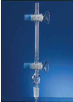
BESTIMMUNG VON CYANIDEN (D 13) PROBENAHMEGEFÄSSE DIN 38 405 - Teil 13 (DEV)
