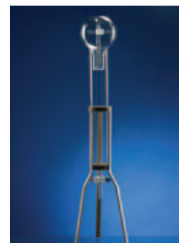
PERKULATOR nach DAB (10. Auflage) beste- hend aus Unterteil mit Hahn, Gestell und Aufsatzkugel
