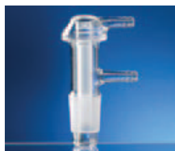
KPG-VAKUUM-RÜHRVER-SCHLÜSSE mit Kühlmantel
