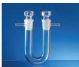
TROCKENROHRE DIN 12 616 U-förmig, seitliche Schlauch- oliven, austauschbare NS-Stopfen
