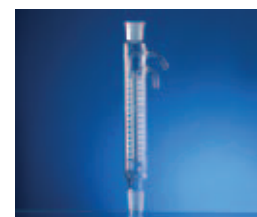
DIMROTH-KÜHLER mit NS-Kern und NS-Hülse DIN 12 591
