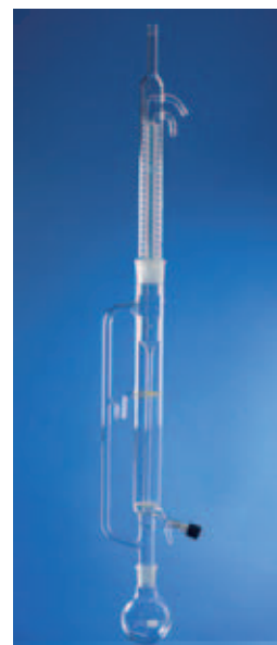
ERSTRAKTIONSAPPARATE zur Extraktion aus Flüssigkeiten für spezifisch leichte Extraktions- mittel, bestehend aus Rundkol- ben, Extraktionsaufsatz, Extrakti- onsfilter, Dimrothkühler (ab 500 ml mit Doppelspirale)
