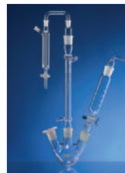
BESTIMMUNG DES GELÖSTEN SULFIDS (D 26) APPARATUR ZUR BESTIMMUNG VON LEICHT FREISETZBAREM SULFID (D 27) DIN 38 405 - Teil 26 + 27 (DEV) bestehend aus Dreihalskolben, Liebigkühler, Übergangsstück, Verbindungsstück, Tropftrichter, Verbindungsbrücke, Zweihals-Scheidetrichter
