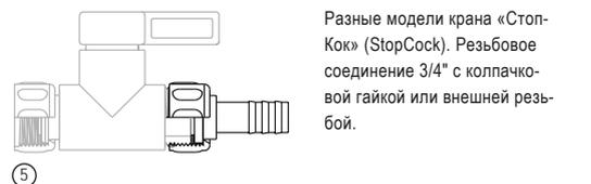
Разные модели крана «СтопКок» (StopCock). Резьбовое соединение 3/4" с колпачковой гайкой или внешней резьбой.
