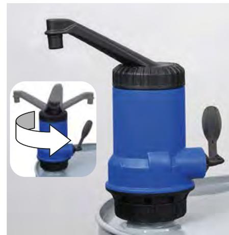
Компактный самовсасывающий рычажный насос из полиэтилена, подходит для лёгких кислот и щелочей. Телескопическая трубка рычажного насоса вытягивается бесступенчато до 100 см, таким образом её можно использовать для бочек на 50-200 л.
