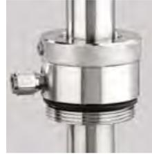
Газонепроницаемое соединение для бочек препятствует утечке опасных газов из бочки. Для стальных бочек с внутренней резьбой R2", обратный клапан с патрубком 1/8". Изготовлено из никелированной латуни, уплотнения из ФПМ.
