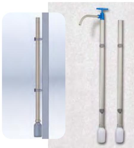
С помощью стойки-сборника для насосов можно безопасно собирать остатки жидкости из трубок насоса или пробоотборников. Стойка-сборник устойчива к действию разбавленных кислот и щелочей. Приёмный резервуар можно заполнять также нейтрализатором, который растворяет и нейтрализует остаточную жидкость. Стойка-сборник прочно крепится к стенке с помощью хомутов. Хомуты просто открываются для демонтажа стойки.
