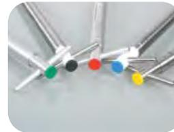
Цветовая кодировка: Маркировка во избежание путаницы в случае с «Мульти-Самплер» (Multi-Sampler) и «Уно-Самплер» (Uno-Sampler).
