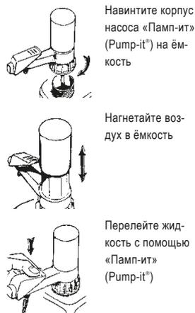
Насос „Памп-ит“ (Pump-it®) для канистр предназначен для быстрого и аккуратного перекачивания жидкостей из канистр и небольших бочек объёмом до 60 л. Перекачивание жидкости осуществляется за счет создания избыточного давления в канистре. Насосы „Памп-ит“ (Pump-it®) подходят для работы со слабыми кислотами, основаниями и нефтепродуктами.
