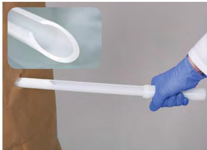
Одноразовый пробоотборник «ПаудерДиспо» (PowderDispo) специально предназначен для отбора проб из разных слоёв порошковых или слегка липких субстанций. Благодаря наличию трубки обеспечивается возможность взятия полной многоуровневой пробы из мешков или небольших ёмкостей.
