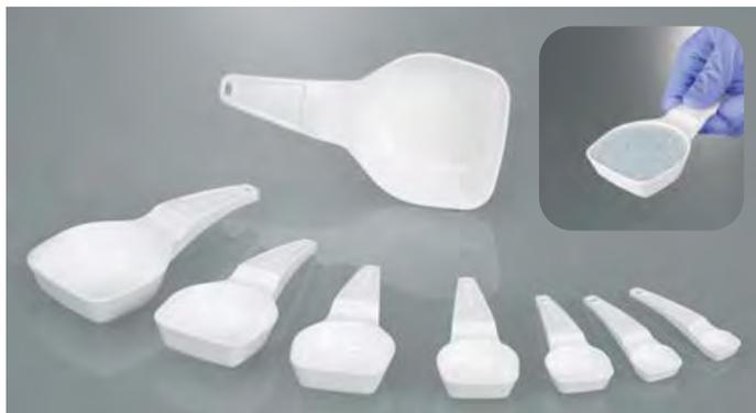
С помощью мерных и дозировочных ложек можно точно отмерять и дозировать небольшие объёмы порошка, гранул и жидкостей. Для точной дозировки избыточный материал подбирается верхней кромкой ложки. Вместительность указана на ручке.
