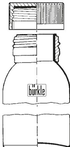
Алюминиевая бутыль прекрасно подходит для хранения, транспортировки и поставки материалов и образцов для сравнения в условиях, исключающих попадание посторонних веществ. Кроме того, они опорожняются полностью, не имеют запаха, непроницаемы для света, устойчивы к коррозии.
