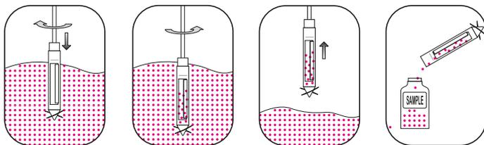
При транспортировке насыпных товаров на большие расстояния (в грузовых машинах или железнодорожных вагонах) может произойти их расслоение. В этом случае отобранный с поверхности материала образец не будет являться репрезентативным. «СилоДрилл» (SiloDrill) позволяет проводить отбор репрезентативных проб из разных слоев зернохранилища. Диаметр 90 мм, что позволяет проводить отбор проб из любых стандартных хранилищ.
