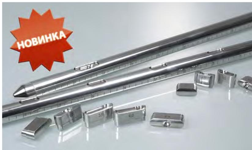
«Новартос» (Novartos) – это зональный фармацевтический пробоотборник для отбора унифицированных проб согласно требованиям FDA. С помощью фармацевтических пробоотборников «Новартос» (Novartos) можно отобрать двойную или тройную пробу (отбор унифицированных проб) из одного или нескольких мест пробоотбора за один раз. За один отбор проб.
