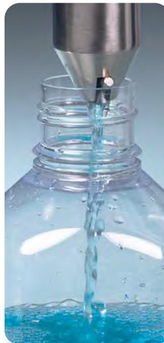
Для опорожнения образца клапан открывается с помощью насадки на контейнере для образцов.
