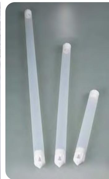
Пробоотборник предназначен для отбора проб грунтовых вод из колодцев, шахт и других источников. Позволяет отбирать пробы из шахт, имеющих диаметр отверстия не менее 2" и не имеющих изгибов и зазоров. Использование высококачественных материалов обеспечивает максимально возможную степень чистоты отбираемых проб. Закругленные края и резьба с круглым профилем упрощают процедуру очистки.
