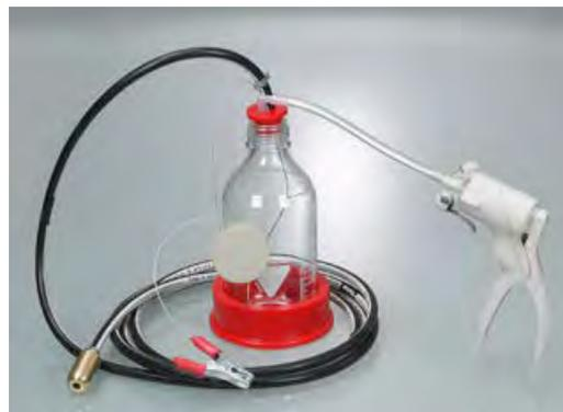
Пробоотборник «УниСамплер» (UniSampler) с гибкой трубкой (ПВХ) и грузом, изготовленным из нержавеющей стали. Предназначен для отбора проб с большой глубины, из труднодоступных мест. Тяжелая металлическая трубка служит для погружения подающей трубки на заданную глубину.
