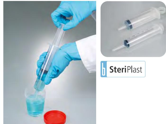
Шприц предназначен для отбора и хранения стерильных проб. Количество образца определяется по нанесенной на шприц шкале. Шприцы поставляются в стерильной упаковке и готовы к немедленному использованию. Специальная трубка позволяет увеличить длину шприца на любую величину. Редукционный адаптер поставляется в комплекте со шприцем емкостью 100 мл.
