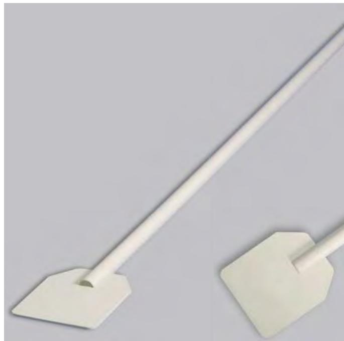
Изготовлено из ПП. Предназначается для неинтенсивного перемешивания в контейнерах, изготовленных из стекла или пластика.
