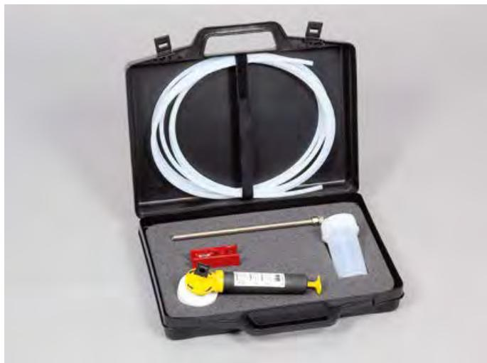
Специально предназначен для случаев, когда требуется обеспечение максимальной степени чистоты пробы.
