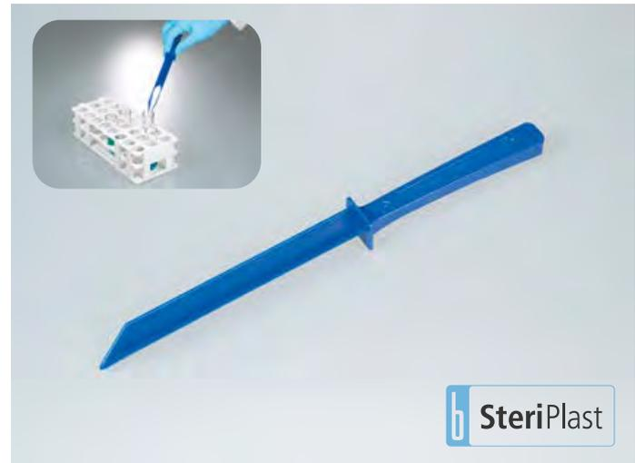
Шпатель для пищевых продуктов «СтериПласт» (SteriPlast®) из синего полистирола изготавливается в нашей чистой комнате класса 7 (10.000). Он раздельно упаковывается для одноразового применения, а затем стерилизуется гамма-излучением.
