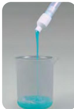
Пробоотборник «ВискоСамплер» (ViscoSampler) предназначен для вязких сред и обладает большой силой всасывания. Набор и выдавливание жидкости производится с помощью отсосной колбы. Изготовлен из высокочистого и химически инертного ПТФЭ/ФЭП, что позволяет избежать загрязнения пробы посторонними веществами. Предназначен специально для работы с вязкими веществами, такими как суспензии, ил, жидкие глины, образцы почв, отложения, масла, эмульсии, крема и т.д.
