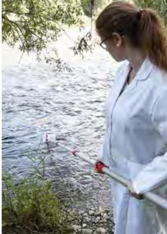
Универсальное приспособление для отбора проб «ТелеСкуп» (TeleScoop) с возможностью установки различных инструментов для решения широкого круга задач. Заменяемые устройства (наклонный стакан, маятниковый стакан, держатель для бутылей, стакан из нержавеющей стали) устанавливаются на телескопический штوك с помощью удобного зажима-защелки.
