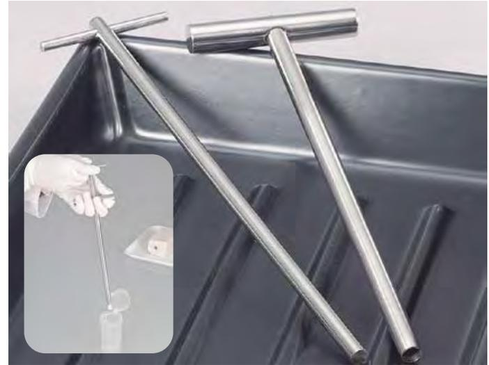
Ручной бурав конической формы, с полукруглым сечением, с острыми режущими кромками и жесткой ручкой. Предназначен для отбора проб мягких пастообразных веществ (сыра, масла, глины, мыла, воска и т.д.).
