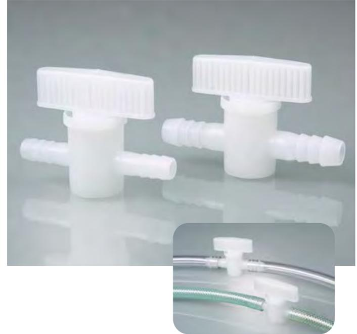
Двухходовые / трехходовые клапаны изготовлены из цельного ПТФЭ и снабжены патрубками для присоединения трубок. Химически стойкие. Кроме того, за счет низкого коэффициента трения, трубки легко соединяются с патрубками клапана. Синие ручки из ПП.
