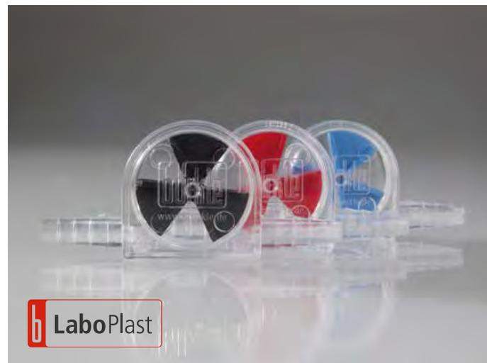
Датчик потока «ЛиквиМобиль» (LiquiMobil) (материал: стирол-акрилни-трил) предназначен, в основном, для установки на системы охлаждения и позволяет значительно снизить количество потребляемой воды за счет лучшей регулировки расхода охлаждающей воды. Не пригоден для работы с агрессивными веществами.
