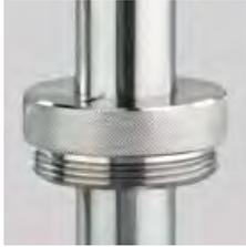
Резьбовое соединение для бочек из никелированной латуни для насоса для бочек из нержавеющей стали. С комплектом для заземления предотвращает накопление статического электричества. Предназначено для работы с горючими и легковоспламеняющимися жидкостями. Устанавливается на ёмкости с внутренней мелкой стальной резьбой R 2".
