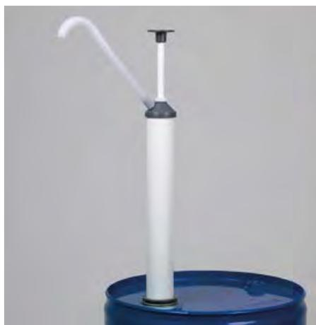
Поршневой насос предназначен для работы с водными растворами и нефтепродуктами. Он характеризуется прекрасным соотношением цена/производительность. Поршневой насос устанавливается на контейнере с помощью внутреннего резьбового соединения 2" или 3/4". После установки насос можно поворачивать вокруг оси так, что ёмкости для заполнения можно устанавливать непосредственно на крышку бочки.
