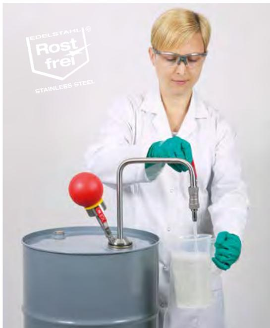
Ручной насос для растворителей предназначен для перекачивания органических растворителей и ароматизаторов. Не загрязняет жидкость. Ручной насос работает по принципу избыточного давления. С помощью насосной груши в ёмкости создаётся избыточное давление, заставляющее жидкость перемещаться из тары.
