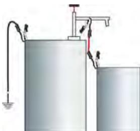
Дополнительная степень защиты: Медный кабель без изоляции служит для заземления при заполнении непроводящих ёмкостей.
