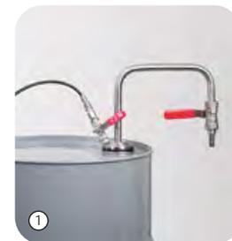
Насос легко крепится в таре с помощью резьбового соединения для бочек. Подключение сжатого воздуха или азота (3-10 бар) можно производить при использовании мобильного или стационарного источника сжатого воздуха.
