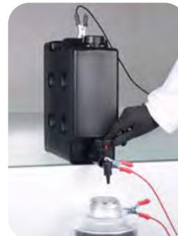
**!** Внимание! При работе с горючими жидкостями канистру следует заземлять! Используйте комплект для заземления!
