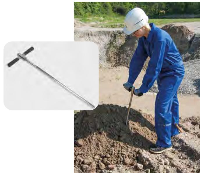
Пробоотборник, отличающийся очень высокой прочностью и предназначенный для отбора проб тяжелых и каменистых почв. Модель 5350-5018 снабжена коническим наконечником длиной 60 см, что упрощает процедуру извлечения пробоотборника из грунта. Позволяет проводить отбор проб грунта для испытаний на содержание связанного азота 0–90 см.
