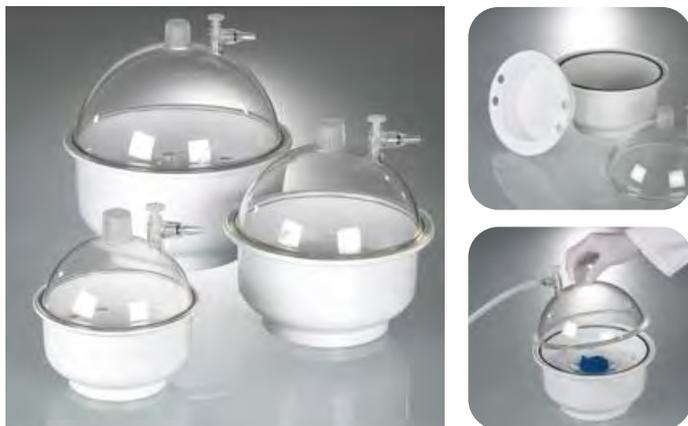
Пластиковые эксикаторы характеризуются очень важными особенностями – малым весом и высокой механической прочностью. Эксикаторы снабжены краном и выдерживают вакуум до  $-740$  mmHg. Основания и тарелки эксикаторов изготовлены из полипропилена. На крышке из высокопрозрачного поликарбоната установлен обратный клапан и выпускной клапан. Уплотняющее кольцо изготовлено из полихлорбутадиенового каучука. Эксикаторы устойчивы к длительному нагреванию до  $+60$  °C.
