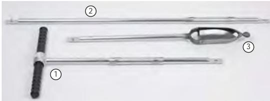
Чрезвычайно прочный пробоотборник с закаленными коваными головками бура. Предназначен для определения свойств грунтов, их влажности и структуры. Форма головок бура «Крот» (Mole) обеспечивает минимальное сопротивление при введении и извлечении пробоотборника. Это способствует снижению физической нагрузки при работе с ним.
