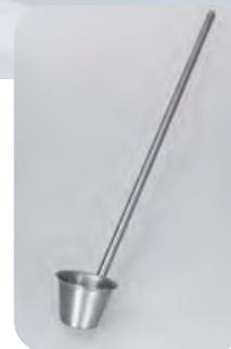
В отличие от черпаков других конструкций не имеет отверстий и технологических неровностей, в которых могут оставаться следы ранее отобранных проб. Отсутствие пор на поверхности металла обеспечивается за счет использования лазерной сварки.
