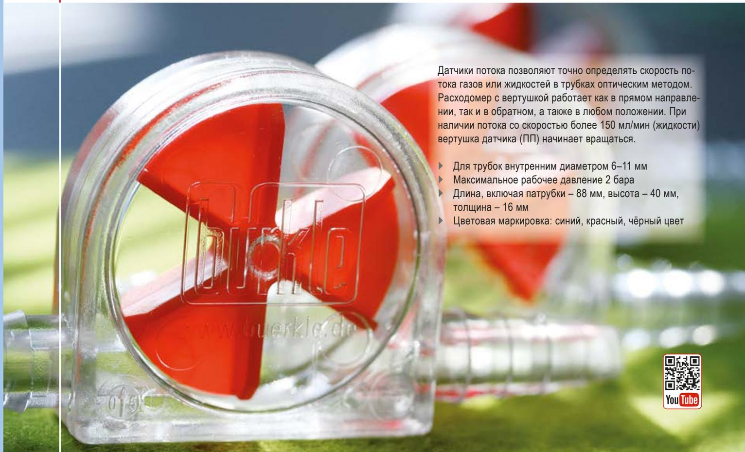
Датчики потока позволяют точно определять скорость потока газов или жидкостей в трубках оптическим методом. Расходомер с вертушкой работает как в прямом направлении, так и в обратном, а также в любом положении. При наличии потока со скоростью более 150 мл/мин (жидкости) вертушка датчика (ПП) начинает вращаться.
