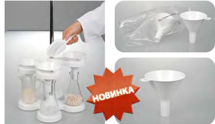
Одноразовая воронка для порошков имеет короткий и широкий выход, она подходит для пересыпания порошкообразных образцов и материалов, гранул, суспензий, а также иных жидкостей. Широкое отверстие одноразовой воронки для порошков предотвращает образование засоров из порошка или гранул во время наполнения. Поэтому это практичное и гигиеничное приспособление для перемещения материалов представляет собой полезный аксессуар как при отборе проб, так и при работе в лаборатории.
