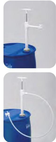
Части насоса, вступающие в непосредственный контакт с жидкостью, изготовлены из ПТФЭ и ФЭП. Эти материалы имеют очень высокую химическую устойчивость, и изделия из них можно использовать для работы с жидкостями, несовместимыми с полипропиленом и ПВХ (за исключением содержащих молекулярный фтор).
