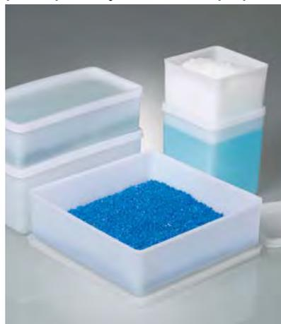
Контейнеры для хранения, упаковки, отбора проб, образцов и транспортировки паст, гранулятов, порошков, проб грунта и замороженных продуктов (-40 °С кратковременно до +95 °С). Оптимальное использование площадей, можно штабелировать. В комплекте с прижимающимися крышками.
