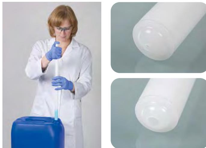
Простой одноразовый пробоотборник для отбора жидкотекучих субстанций. Если «ДиспоПипетт» (DispoPipette) вводится в жидкость в открытом состоянии, тогда отбирается многоуровневая проба. Если же осуществляется ввод в закрытом состоянии, а уже после ввода производится открытие, тогда производится точечный пробоотбор. Очень простое обращение. Два размера отверстия (2,5/5,5 мм) для различных степеней вязкости.
