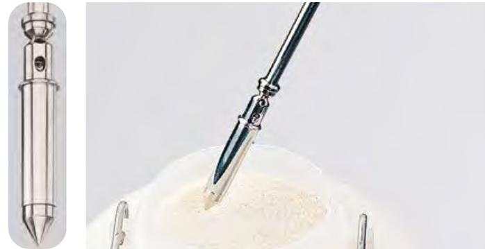
Предназначен специально для отбора очень малых по объёму проб сильнорействующих, дорогостоящих или химически активных порошкообразных препаратов. С помощью пробоотборника «ФармаПикер» (PharmaPicker) можно отбирать пробы очень малого объёма – от 0,1 до 2,5 мл. С помощью простой смены наконечников в цилиндрах для сбора образца для 0,1–1,2 мл или 1,25–2,5 мл меняется объём.
