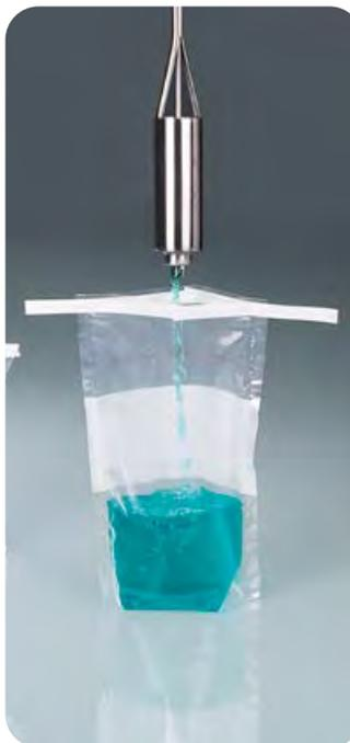
Для опорожнения образца клапан открывается с помощью большого пальца.
