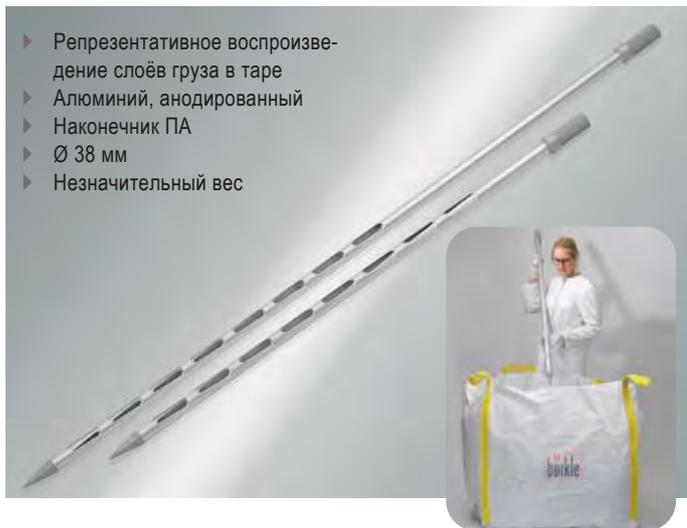
Обеспечивает точный зональный отбор проб через все слои насыпного груза. Вследствие спиралевидного расположения пробозаборных шлицев они открываются с задержкой по времени снизу вверх. Таким образом, заполнение происходит сначала через самое нижнее отверстие, а затем через последующие отверстия снизу вверх, пока не заполнится весь «Спиралус».
