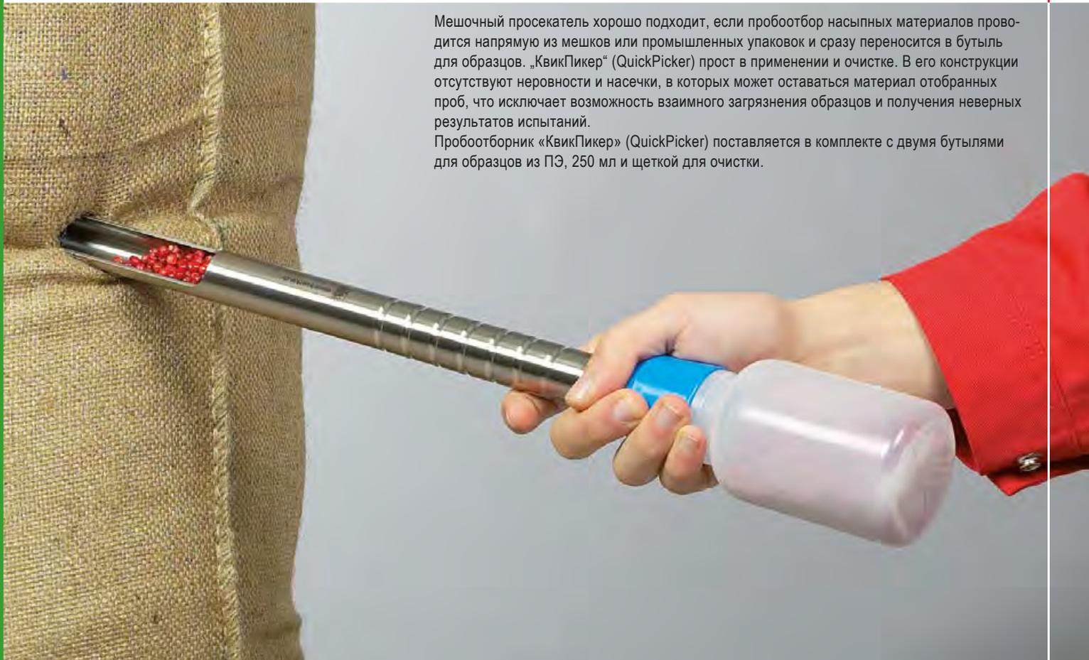
Мешочный просекатель хорошо подходит, если пробоотбор насыпных материалов проводится напрямую из мешков или промышленных упаковок и сразу переносится в бутылку для образцов. «КвикПикер» (QuickPicker) прост в применении и очистке. В его конструкции отсутствуют неровности и насечки, в которых может оставаться материал отобранных проб, что исключает возможность взаимного загрязнения образцов и получения неверных результатов испытаний.
