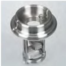
Универсальный резьбовой адаптер почти для всех бочек и другой тары с диаметром отверстия 48-75 мм, независимо от имеющейся резьбы. Резьбовой адаптер можно установить быстро и просто с помощью натяжных винтов. Его можно использовать для различных отверстий в емкостях. С соединительной резьбой G2" для бочковых резьбовых соединений Bürkle и насосов с диаметрами погружных трубок до 32 мм.
