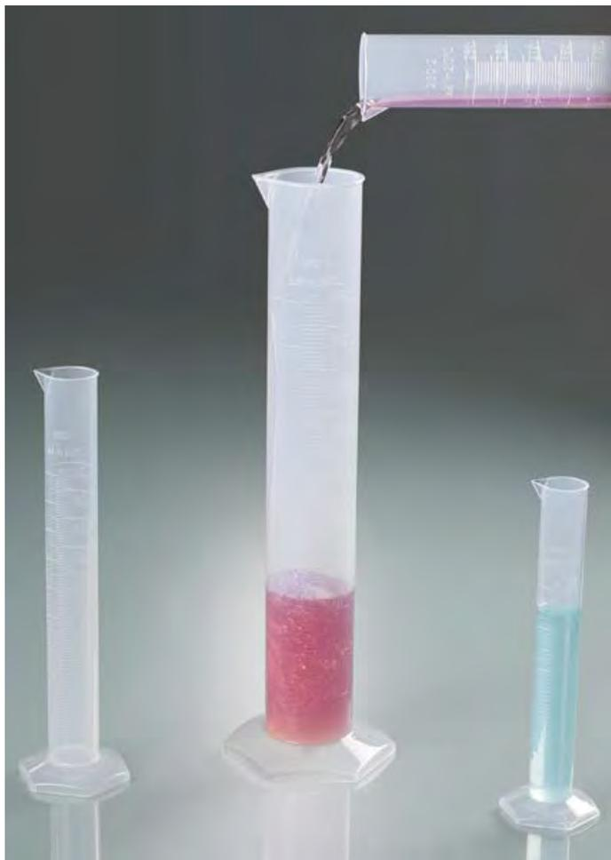
Градуированные цилиндры, высокие, соответствуют DIN 12681 (стекло) / ISO 6706, шестиугольное основание. Предназначены для использования в лабораториях, аптеках, в производственных и полевых лабораториях. Необходимы везде, где требуется определение объема.
