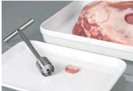
Пробоотборник для мяса «БифСтикер» (BeefSteaker) для ручного вырезания фрагмента ткани для микробиологического исследования поверхности туши животного. Буровая коронка вкручивается вручную.
