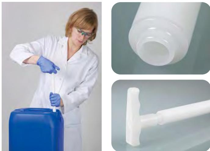
С помощью одноразового пробоотборника «ВискоДиспо» (ViscoDispo) возможен забор проб из высоковязких субстанций со значением вязкости до 100.000 мПас. Ручка эргономичной формы и очень стабильная тяга облегчают засасывание даже вязких субстанций.
