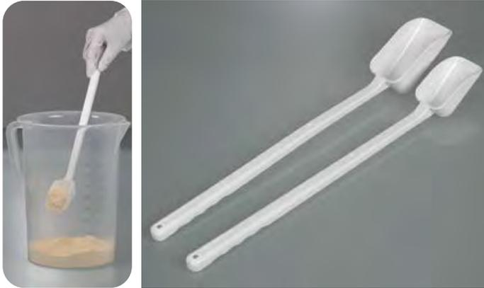
Пробоотборный совок можно использовать для отбора проб из порошков, гранулятов и паст. При этом длинная ручка позволяет производить забор проб даже из большой тары с незначительным содержанием или через узкие отверстия. Благодаря прямой нижней кромке совка можно забирать материал непосредственно со дна ёмкости.
