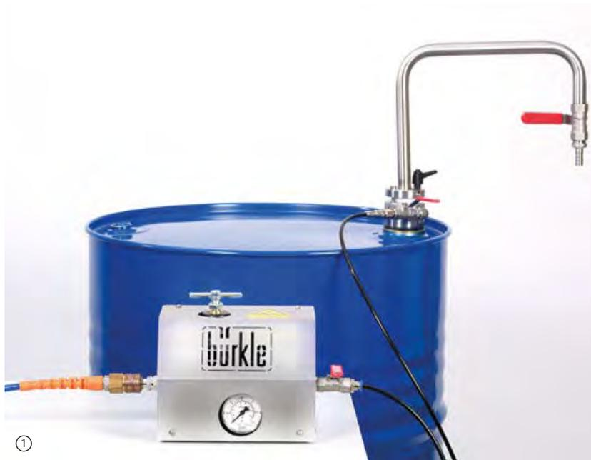
Система для отбора растворителей позволяет осуществлять быстрый и удобный розлив жидкостей высокой степени очистки. С помощью сжатого газа (сжатого воздуха или азота) в таре создаётся избыточное давление, вытесняющее жидкость из ёмкости. Преимущество использования сжатого газа состоит в том, что пользователь без труда может производить также отбор больших объёмов. При этом для розлива растворителя у него остаются свободными обе руки.
