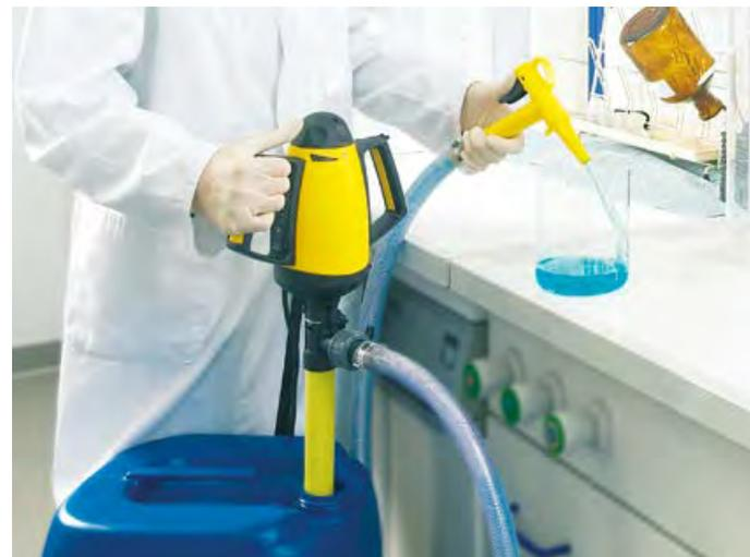
Насос с небольшим весом и высокой производительностью для перекачки жидкости с вязкостью до 300 мПа·с из канистр, бочек и сосудов с узким горлышком диаметром от 32 мм.
