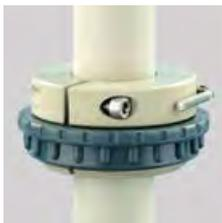
Резьбовое соединение для ёмкостей обеспечивает установку насоса на любой участок стенок ёмкости, либо на резьбовых крышках с широкими кромками. Резьбовое соединение 2" закрепляется с обратной стороны с помощью контргайки 2" (монтажное отверстие ёмкости 60 мм).
