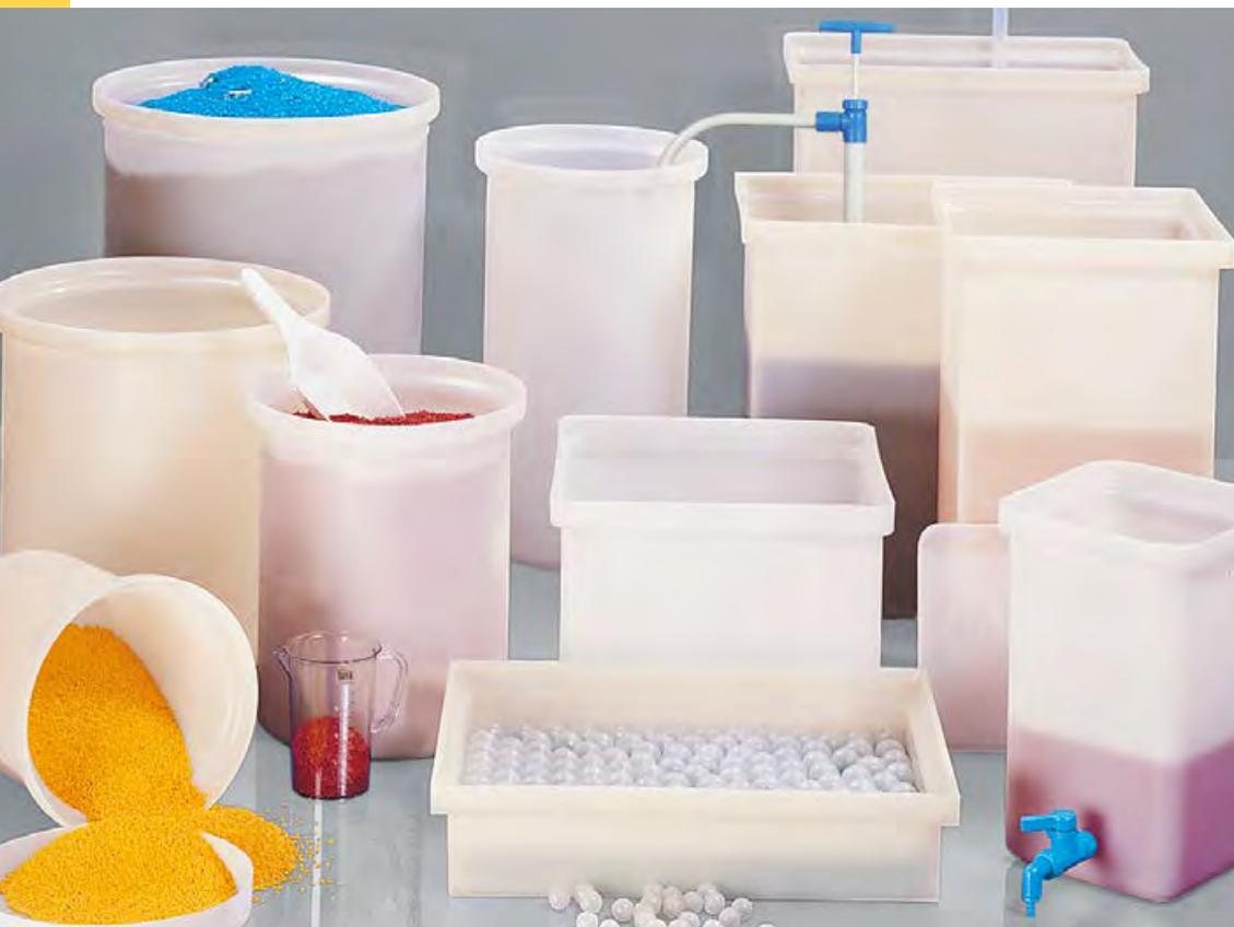
Контейнеры для различных случаев применения. Ёмкости, изготовленные по методу LaboPlast®-Sinter не имеют стыков и швов, структура полимера однородная и не имеет внутренних напряжений. Толщина стенки увеличивается сверху вниз, тем самым обеспечивается оптимальное распределение нагрузки, создаваемой наполняемым материалом, по высоте стенок. Возможно индивидуальное изготовление в чёрном цвете для защиты от ультрафиолета а также с другой толщиной стенок. Штучное производство, обмен исключён.
