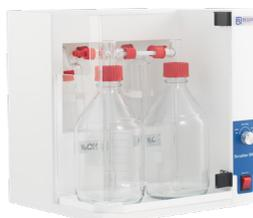
Скруббер SWP предназначен для отвода и дальнейшей нейтрализации токсичных паров и газов, образующихся при сжигании образца. Пары проходят двухступенчатую нейтрализацию. Извлечение паров происходит с помощью встроенного в скруббер вакуумного насоса, который собирает пары испарения и газы, образующиеся при работе дигестора, нейтрализует их сначала в растворе щелочи в щелочь, а далее проводит дополнительную очистку через водный раствор.
