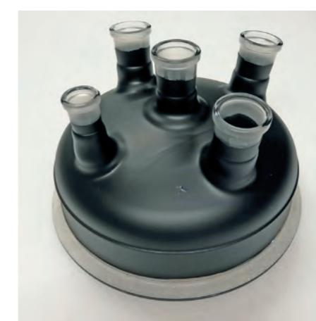
Reaktor und Deckel mit UV undurchlässiger Sicherheitsbeschichtung
