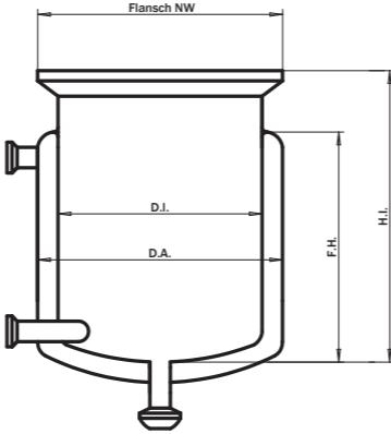
**Bauchige Reaktoren mit Heizmantelanschluss DN15 Flansch**
