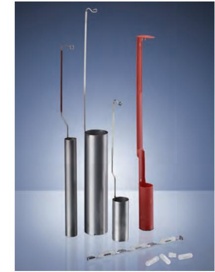
**Flüssigstickstoff-Behälter aus Aluminium
