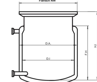
**Bauchige Reaktoren mit Heizmantelanschluss DN15 Flansch und 10 mm „J“ Ventil**
