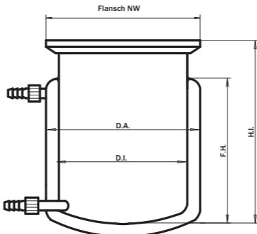
**Temperierbare Reaktionsgefäße mit Heizmantelanschluß DN15-Flansch**
