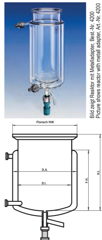
**Temperierbare Reaktionsgefäße mit Heizmantelanschluss DN15-Flansch und 20 mm "J" Ventil**
