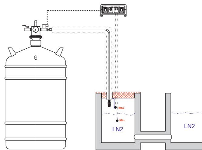
Automatische LN2-Niveauregulierung mit einem korrespondierenden Dewargefäß
