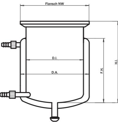
**Temperierbare Reaktionsgefäße mit Heizmantelanschluss DN15 Flansch und Ablauf S40-Schliff**
