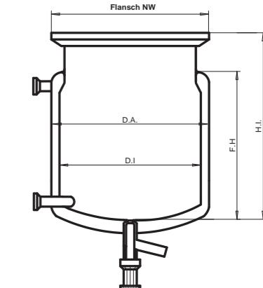
**Bauchige Reaktoren mit Heizmantelanschluss DN15 Flansch und 20 mm „J“ Ventil**
