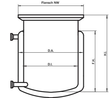
**Temperierbare Reaktionsgefäße mit Heizmantelanschluß GL18-Olive und 10 mm "J" Ventil**
