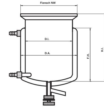
**Temperierbare Reaktionsgefäße mit Heizmantelanschluss DN15-Flansch und "L" Ventil**
