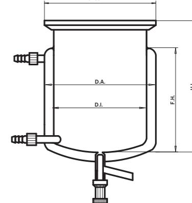
**Temperierbare Reaktionsgefäße mit Heizmantelanschluss DN15-Flansch und 10 mm "J" Ventil**
