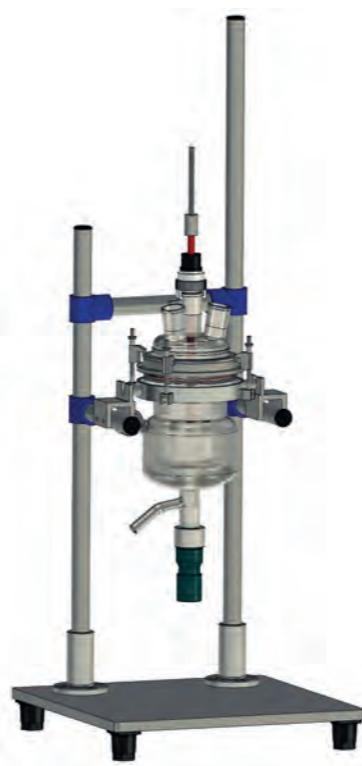
Tischgestell NE (Rohrdurchmesser 27mm)
