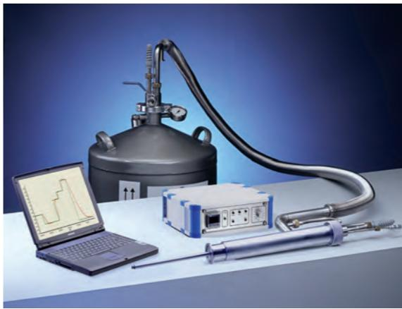
KALTGAS-System Typ TG-LKF für einen Temperaturbereich von  $+100^{\circ}\text{C}$  bis  $-180^{\circ}\text{C}$ , mit einer Temperaturstabilität bis  $\pm 0,2^{\circ}\text{C}$ .
