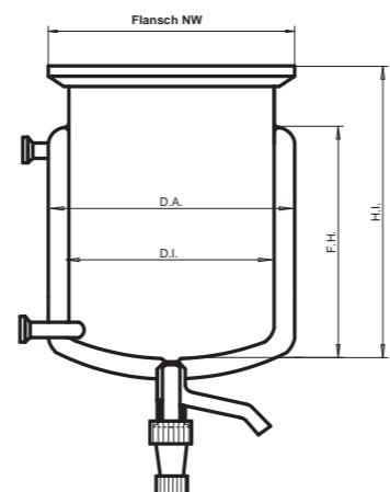
**Temperierbare Reaktionsgefäße mit Heizmantelanschluss GL18-Olive und "L" Ventil**
