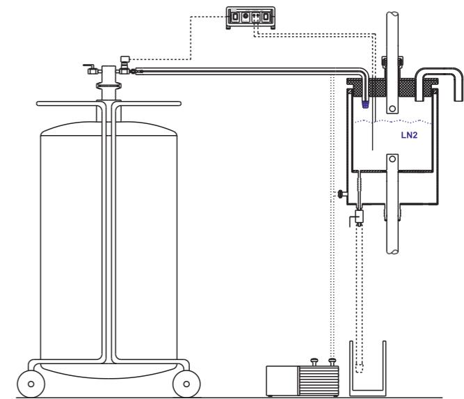
Automatische LN2-Niveauregulierung an einem Dewargefäß für Zugversuche
