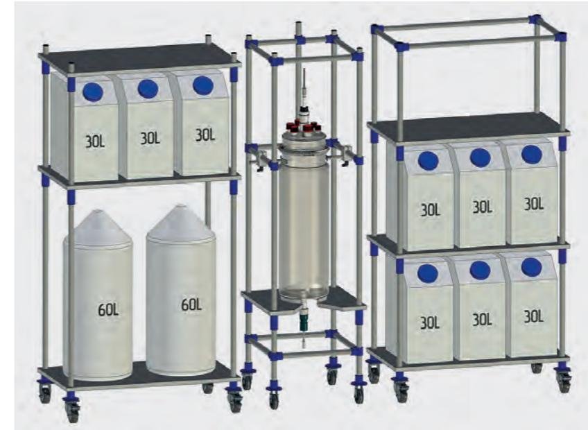
Fahrbarer Reaktor mit mobilen Dosiergestellen /
