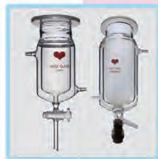
三层反应釜体 (配下出料) Jacketed reactor
