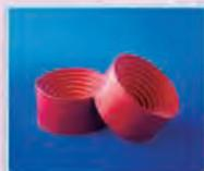
橡塑烧瓶托 (可放置5-2000ml容量的圆底烧瓶)
