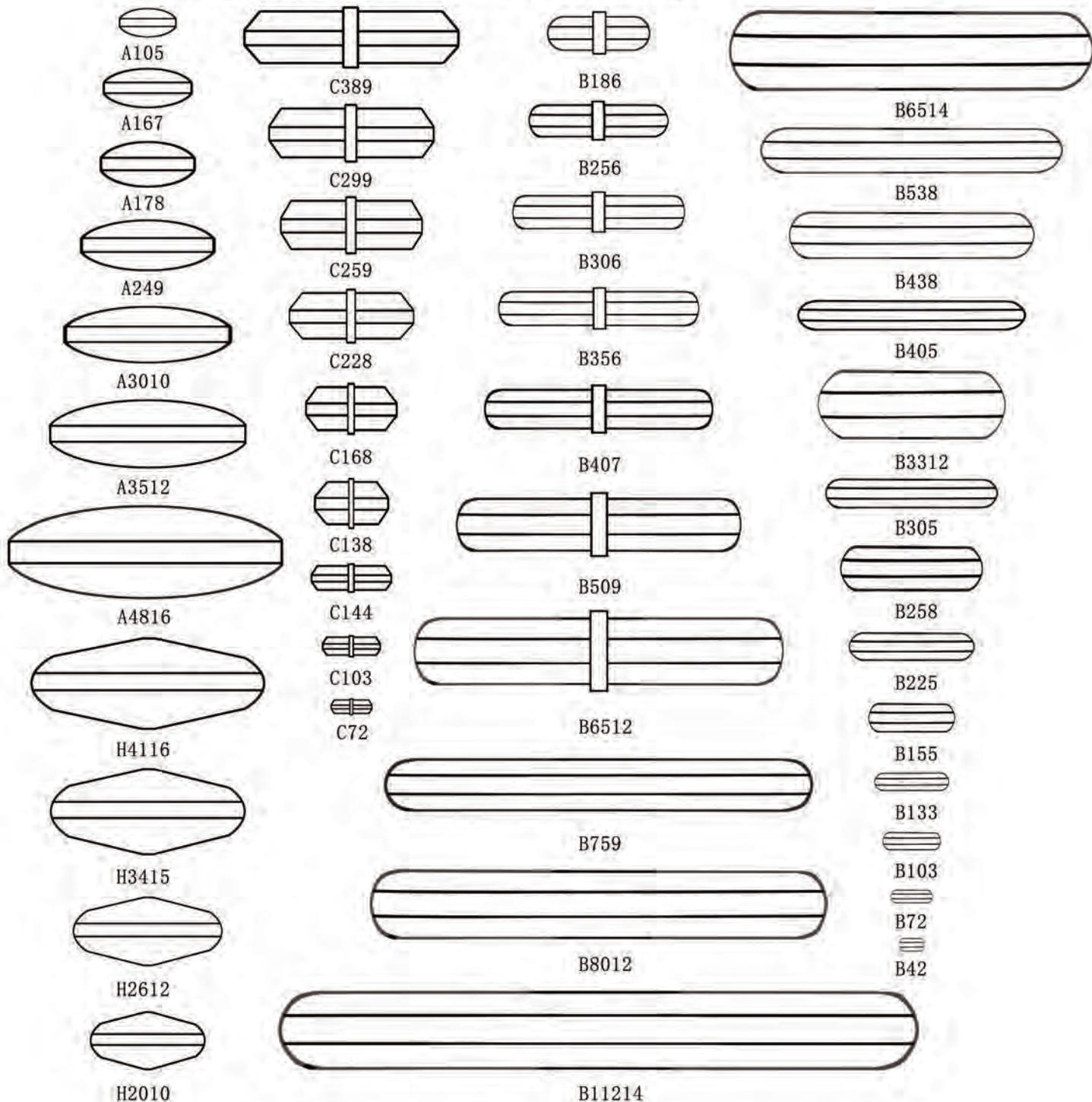
四氟磁力搅拌子型号、参数、形状、尺寸如上图所示，图纸比例1:1。
