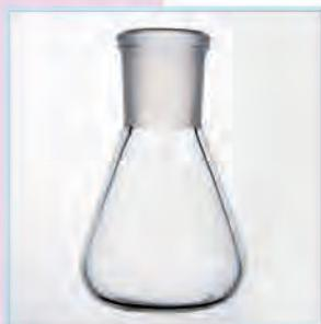
磨口石英三角烧瓶 Quartz erlenmeyer flask
