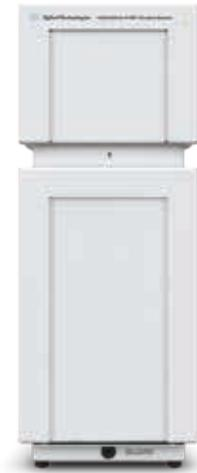
Модуль управления системы Agilent 1260 для сверхкритической флюидной хроматографии
