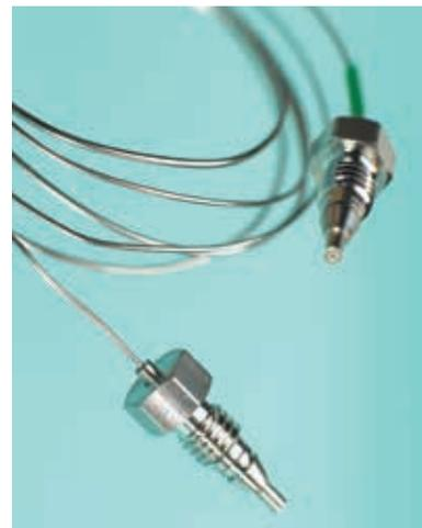
Уникальный процесс лазерной сварки от Agilent обеспечивает абсолютно плоские концы капилляров, что исключает возможность образования мертвого объема из-за несовершенства капилляров.
