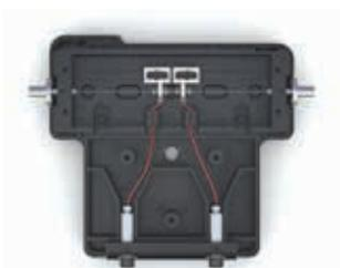
Проточная кювета с высоким динамическим диапазоном Agilent InfinityLab Max-Light HDR, внутренний вид, демонстрирующий малую длину оптического пути (3,7 мм) для работы с высокими концентрациями, G4212-60032
